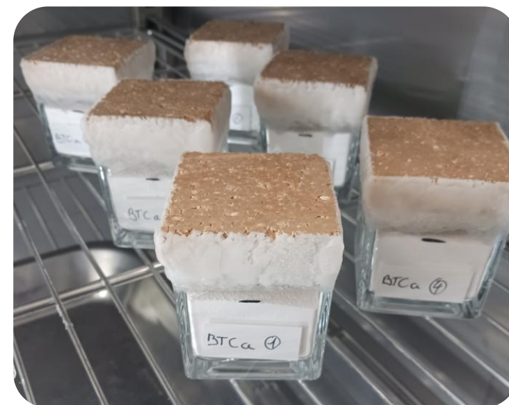
Éprouvette : 60 x 60 x 15 mm 3
